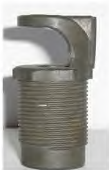
Рисунок 5.29 – Дефлекторная насадка разработанная «ОрТех»
