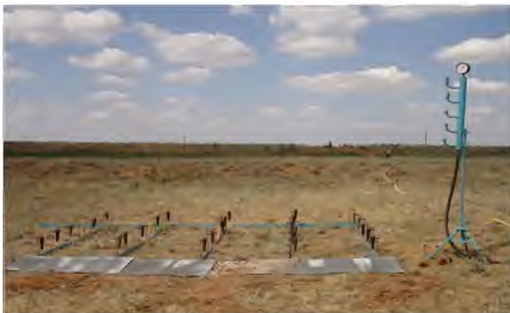
Рисунок 5.33 – Установка для исследования дождевальных насадок
