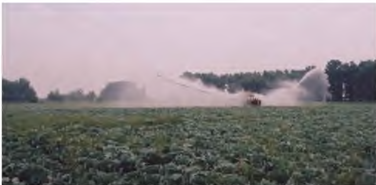
Рисунок 5.14 – Дождевальная машина ДКДФ-1 «Ростовчанка» в работе (поле № 4, ООО «Агросфера» Азовский район Ростовской области)
